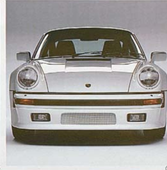
Abb. 1 Mittelkonsole »C« verschiedene Geräte-Einbauten möglich. Abb. 2 911 Turbo Flachbau mit Klappscheinwerfer, Bugspoiler und Mittelölkühler. Abb. 3 Bugspoiler mit großem Mittelölkühler und Weitstrahler.
