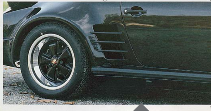
Abb. 4 Lufteinlassschicht am Hinterkotflügel.
